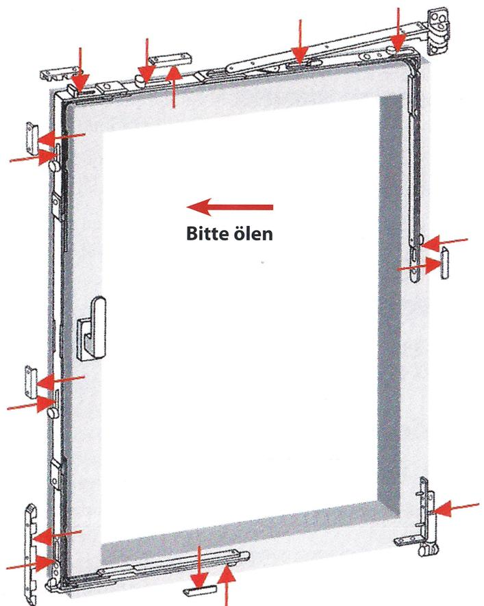
Beschläge sind technisch erforderliche Funktionsbauteile, die teilweise auch bei geschlossenem Fenster sichtbar sind. Abdeckkappen und Farbbeschichtung auf Beschlagteilen müssen gesondert vereinbart und vergütet werden.
